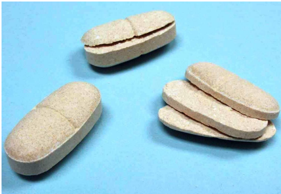
Figura 6: Ejemplos de “Capping” y Laminación/ “Lamination” de tabletas (European Pharmaceutical Manufacturer, 2018).
