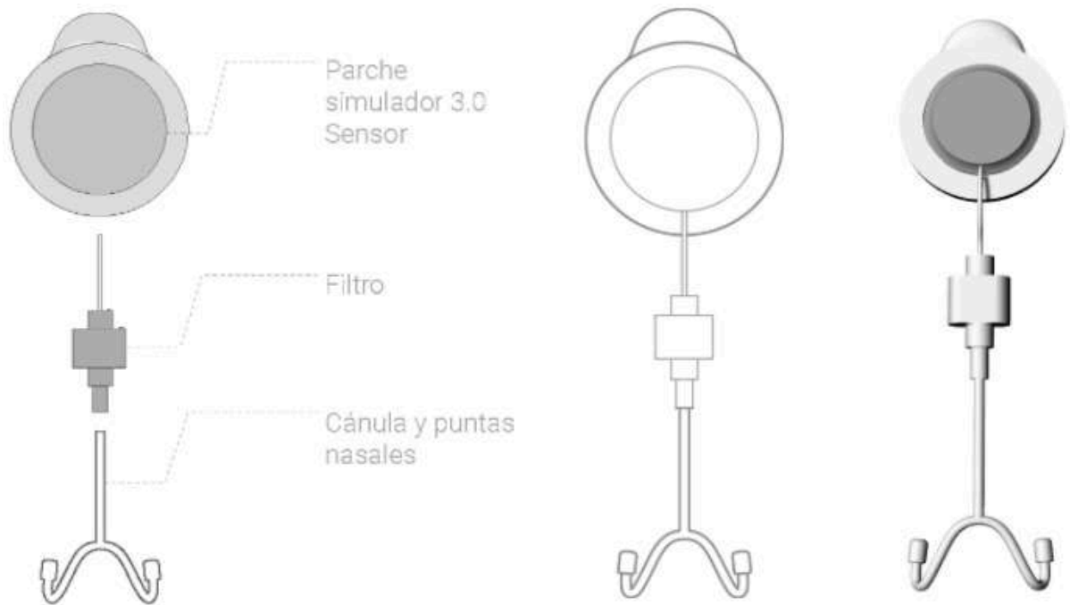
Figura 5.74. Diseño simulador 3.0 de parche y digrama de colocación.
