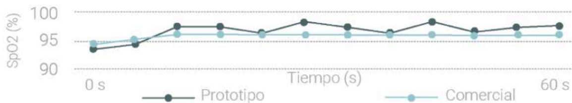
Figura 6.08. Prueba 2.0 en el dedo. Gráfica comparativo prototipo contra oxímetro comercial. 95
