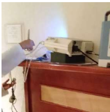
Figura 7.67. Conexión del sensor de oximetría al receptor.
