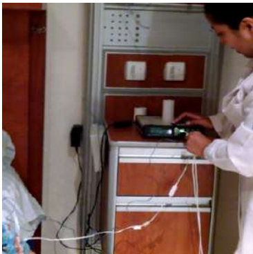
Figura 7.79. Conexión del sensor de oximetría al receptor.
