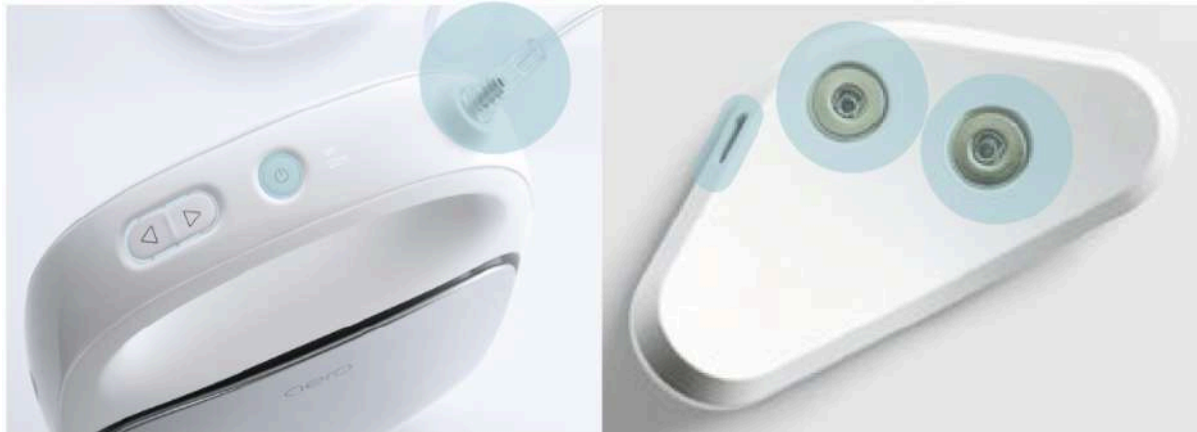
Figura 5.20. Izquierda-uni3n de rosca, de cánula nasal con dispositivo. Derecha-uni3n de electrodos y puerto micro usb. Imágenes disponibles en el sitio: www.pinterest.com.mx/momonicapioquin/análogosdispositivos-médicos/
