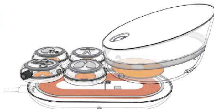
Figura 6.79. Ilustración de bobina transmisora que corresponde al cargador de inducción y las bobinas receptoras a los sensores y receptor.
