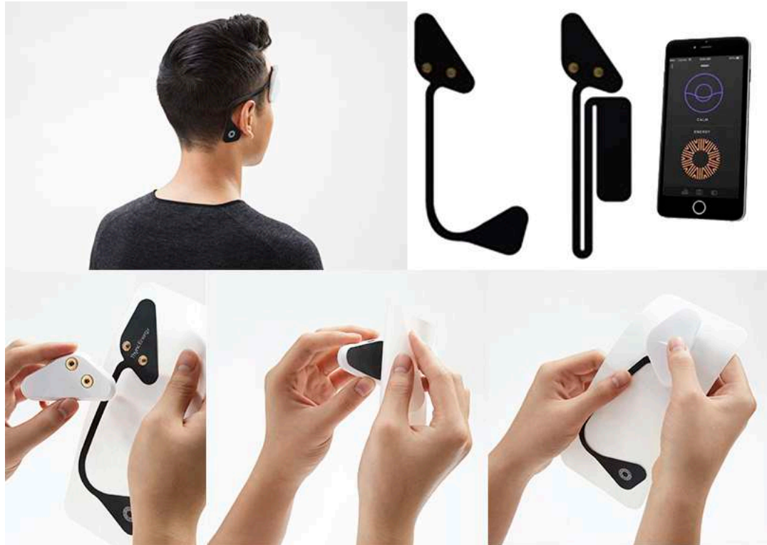
Figura 5.29. Thync Calm and Energy, wearable que reduce el estrés, ubicado en cabeza y cuello. Dispositivo, tiras adhesivas y app móvil. Secuencia de colocación de tiras adhesivas en el dispositivo. 49
