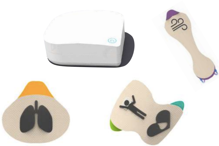
Figura 5.05. Receptor y sensores con fundas para esfuerzo respiratorio, actigrafía - oximetría y flujo respiratorio.
