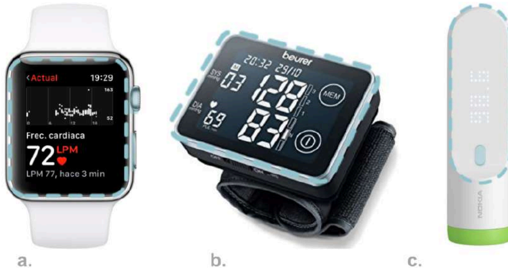
Figura 5.18. Tipos de pantallas a)OLED táctil, b)LED, c)iluminación por medio de LED RGB. Imágenes disponibles en el sitio: www.pinterest.com.mx/momonicapioquin/analogosdispositivos-médicos/
