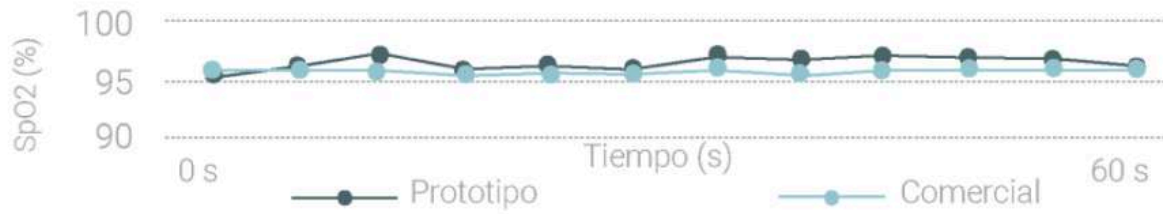
Figura 6.10. Prueba 2.0 en el pulso radial, muñeca. Gráfica comparativo prototipo contra oxímetro comercial. 95
