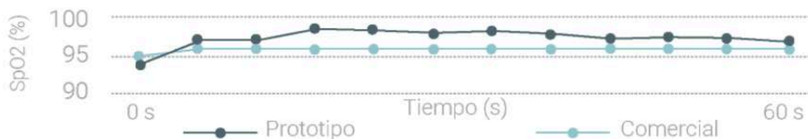
Figura 6.07. Prueba 1.0 en el dedo. Gráfica comparativo prototipo contra oxímetro comercial. 87
