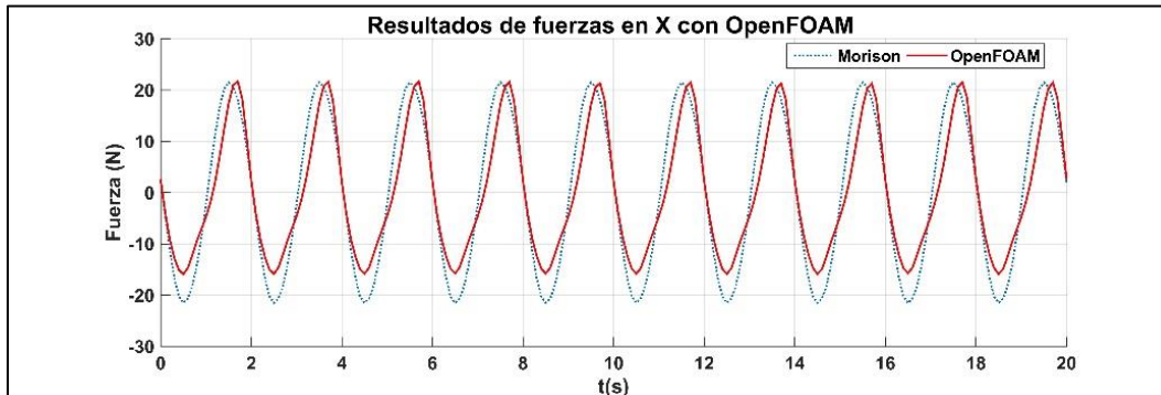
Fig. 39 Comparación de fuerzas obtenidas analíticamente y con OpenFOAM para el cilindro cimentado
