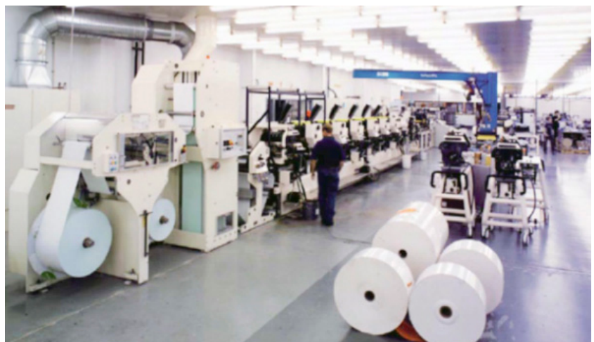
Figura 10 Equipo flexográfico para la fabricación de etiquetas en bobinas.
