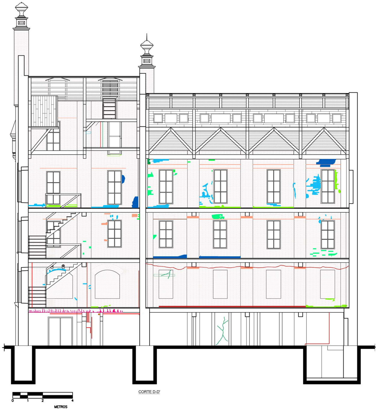
Figura 130. Planos de deterioros. Corte D-D'. Los muros de tabique han recibido la húmedas desde la cubierta de lámina y los canales de bajadas pluviales en mal estado.
