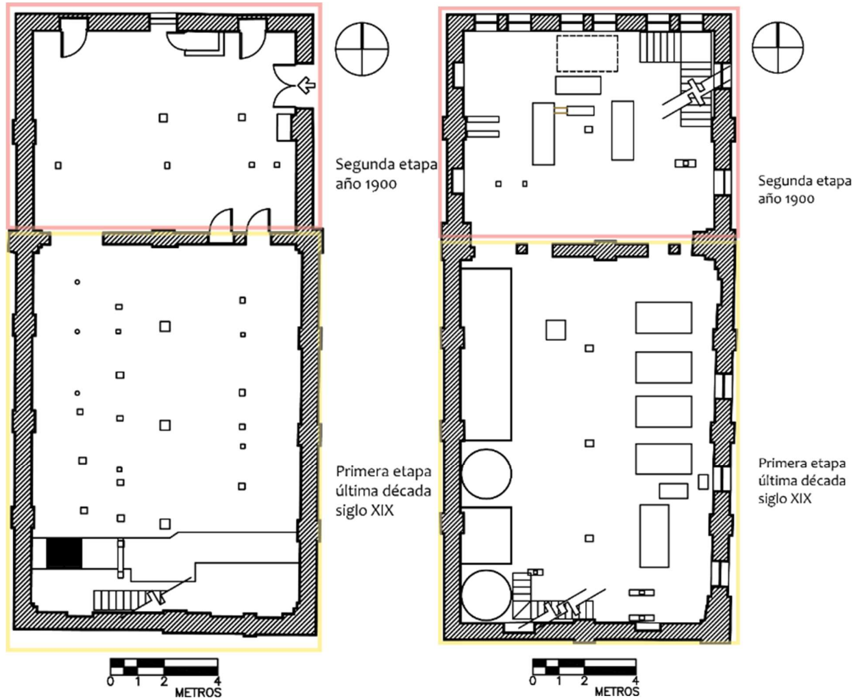
Figura 87 y 88. Levantamiento del estado actual. Planta primer nivel (derecha) y segundo nivel (izquierda), a partir del primer nivel se integra una escalera más en la crujía norte. Se indica por medio de rectángulos la ubicación de la maquinaria existente. Elaboración por M.A.R.C.
