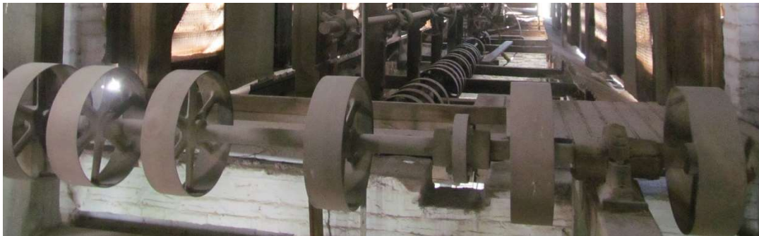
Figura 113. Archivo M.A.R.C. Ruedas que eran para hacer girar las bandas que ayudaban al funcionamiento de la maquinaria.
