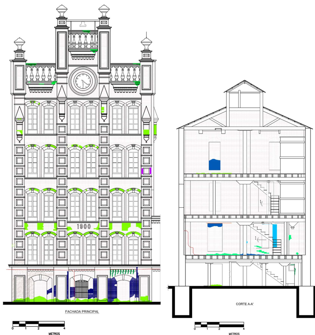
Figuras 126 y 127. Planos de deterioros. Fachada principal y corte A-A'. El mayor daño se refleja en el tabique aparente por la erosión, el tránsito peatonal y vehicular pesado y las fuertes lluvias de verano.
