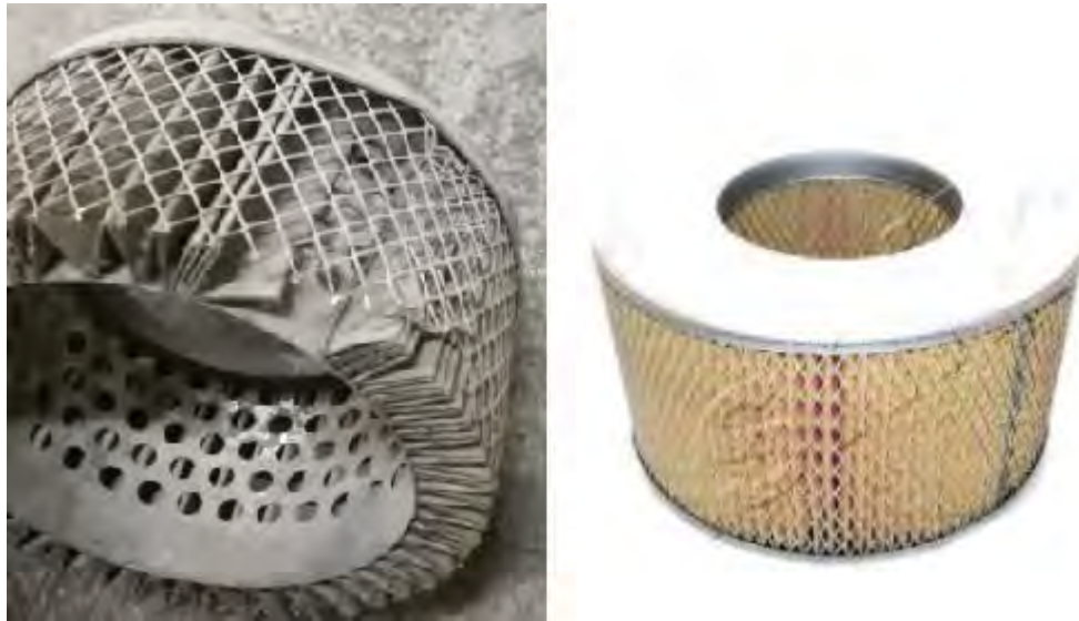
Figura 34. Filtro encontrado en la instalación VS filtro nuevo. Elaboración propia con fotografía de la planta e imagen de internet.
