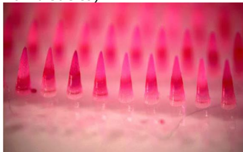
Figura 6. Microagujas solubles. Su tamaño es de 500\mu\text{m} . Microagujas fabricadas por copolimerización de dos monómeros líquidos - vinilpirrolidona (VP) y ácido metacrílico (MAA) (Sullivan, 2008).
