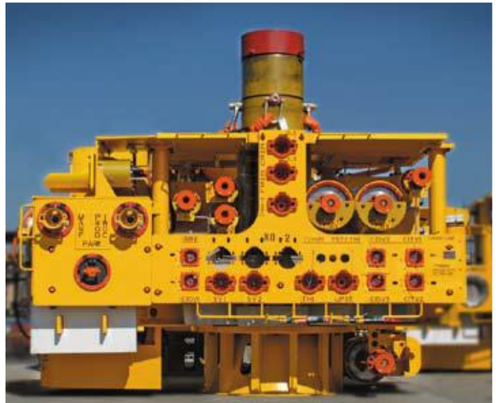
Fig.2.5 Árbol tipo horizontal (FMC) 26
