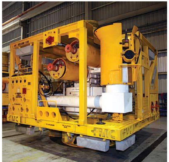
Fig. 2.4 Árbol tipo vertical (FMC) 25
