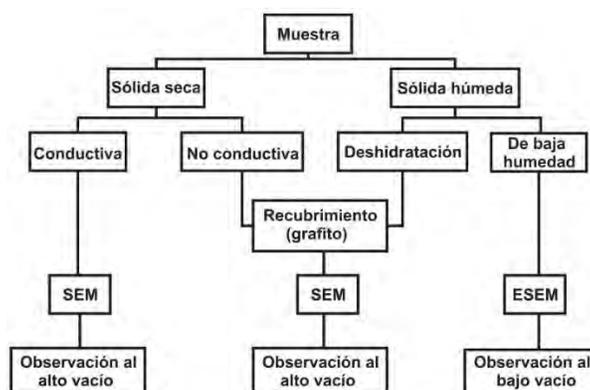
**Figura 2.14.** Procedimiento sugerido para el análisis de muestras con el SEM y ESEM.
