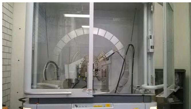
**Figura 2.12** Difractómetro EMPYREAN equipado con filtro de Ni, tubo de cobre de foco fino y detector PIXcel3D, del Laboratorio de Difracción de Rayos X, del Departamento de Geoquímica, en el Instituto de Geología, UNAM.
