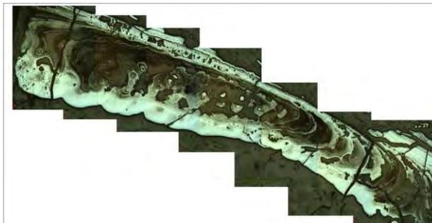
**Figura 4.32** Corte basal de estructura estromatolítica, con bandas elipsoidales de óxidos de Mn y cortados por vetillas de calcita, de longitud total de 5 cm.
