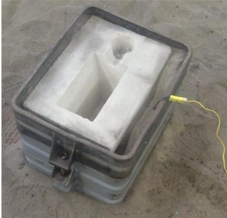
**Figura 19.** Molde de Silicato – CO<sub>2</sub>.
