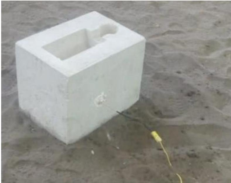
**Figura 20.** Muestra el molde terminado con su orificio respectivo para el termopar, ubicado en el centro de la pieza.
