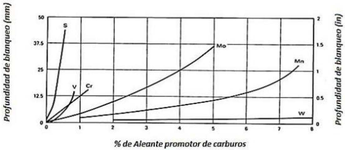
**Figura 2.** Representación del % de aleante promotor de carburos vs profundidad de blanqueo en mm o in.
