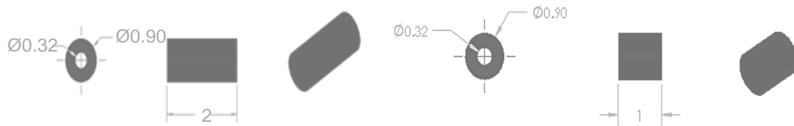
Bujes de madera. Sostienen el núcleo del rotor.
