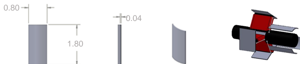
Figura 1.16. Delgas del colector o conmutador.
