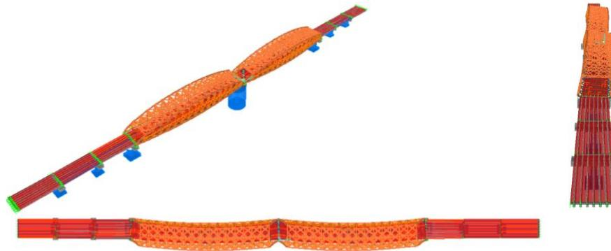
Figura 6.10 Primer modo de vibrar del puente, Vista (Panorámica, transversal y Planta)
