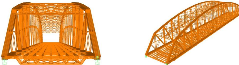
Figura 4.12 Modelo de armadura tipo camelback.
