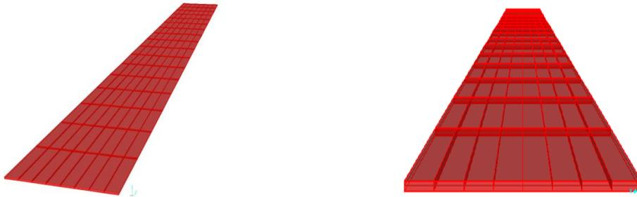
Figura 4.11 Modelo de la losa (diafragma rígido) un tramo de armadura.
