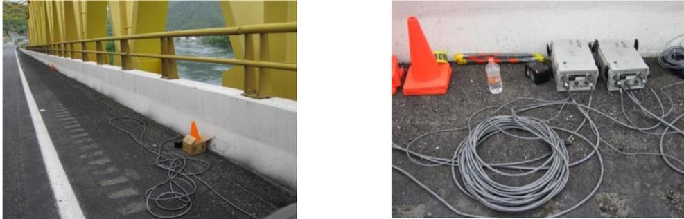
Figura 6.26 Distribución de los sensores a lo largo del puente vehicular infiernillo I
