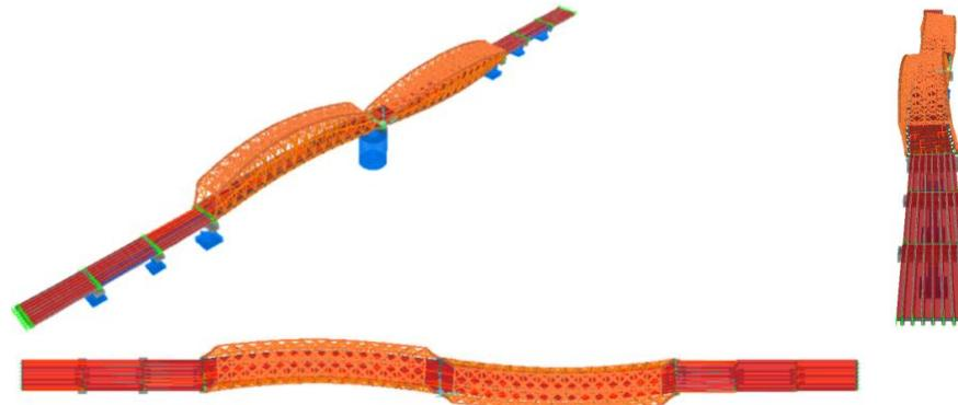
Figura 6.11 Segundo modo de vibrar del puente, Vista (Panorámica, transversal y Planta)
