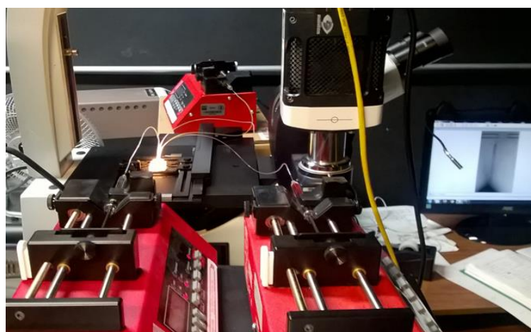
Figura 34. Sistema 2. En el centro del microscopio se encuentra nuestro microchip, las bombas para jeringa que se encuentran en la parte baja de la imagen introducen los fluidos (agua y aceite) con los cuales se forman las microgotas que harán pulsar la interfase. El canal de la interfase se encuentra conectado a una bomba que se sitúa al fondo de la imagen, y que nos permite llenar el canal con agua o poliácridamida, con la cual podremos formar la interfase. Por último, junto al cable amarillo se localiza nuestra cámara de video de alta velocidad que nos permite grabar los experimentos.
