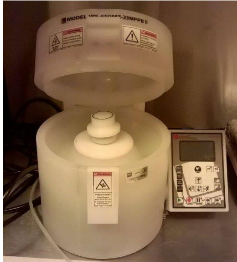
Figura 20. Spin coater, es un equipo utilizado para la fabricación de moldes para sistemas microfluídicos construidos a partir de fotolitografía suave.
