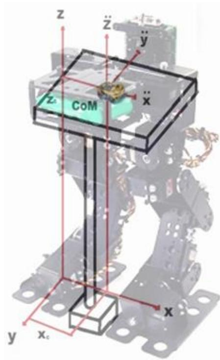
Figura 2.12. Ejemplo de aplicación del sistema mesa-carro en el robot bípodo
