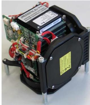
Figura 1.27. Sistema de medición inercial de robot LOLA [42]
