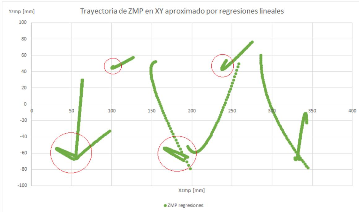
Figura 3.19. ZMP aproximado por regresiones lineales en el plano XY durante la marcha
