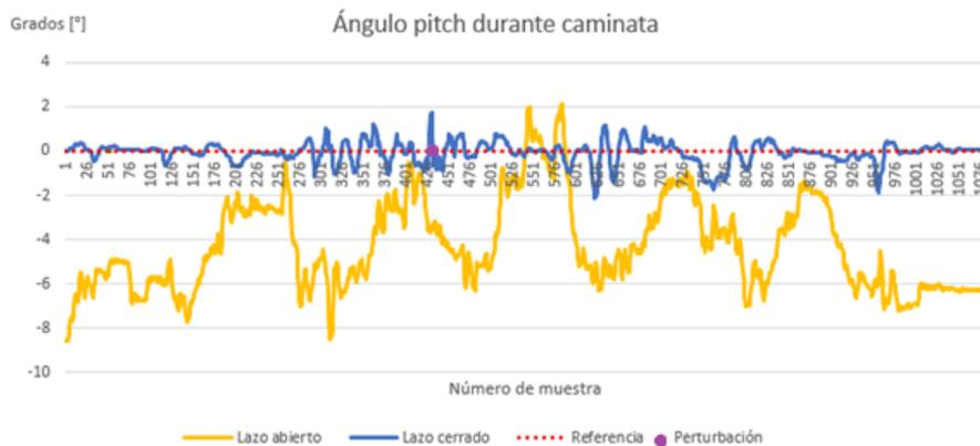
Figura 5.5. Ángulos pitch de la cadera durante la caminata sobre superficie inclinada cinco grados en dirección pitch
