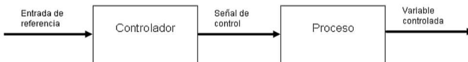
Figura 4.2. Ejemplo de diagrama de bloques de sistema de lazo abierto
