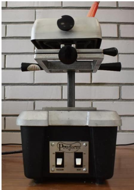
**Figura 23. Máquina termoplástica de vacío.**
