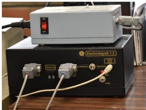
**Figura 19. Electromiógrafo.**
