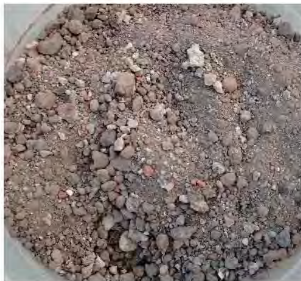
Figura 4.2. Residuos de construcción 1/4" a finos todo en uno
