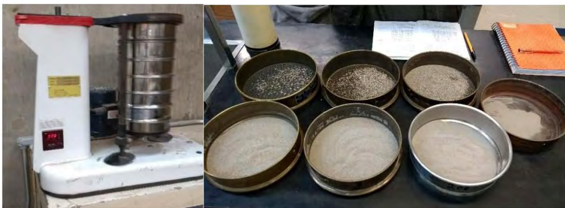
Figura 3.3. Análisis granulométrico por tamizado
