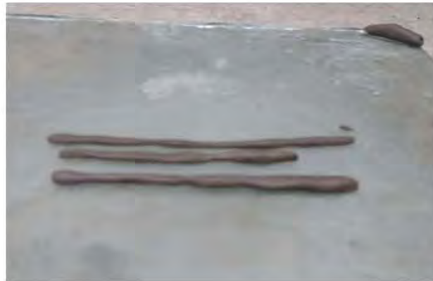
Figura 4.11. Límite plástico del material de excavación
