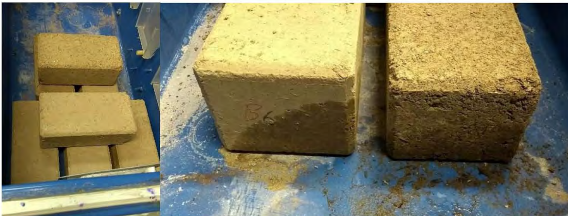
Figura 4.31. Recobloques durante la prueba de intemperismo
