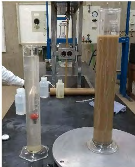
Figura 3.4. Análisis granulométrico por hidrómetro
