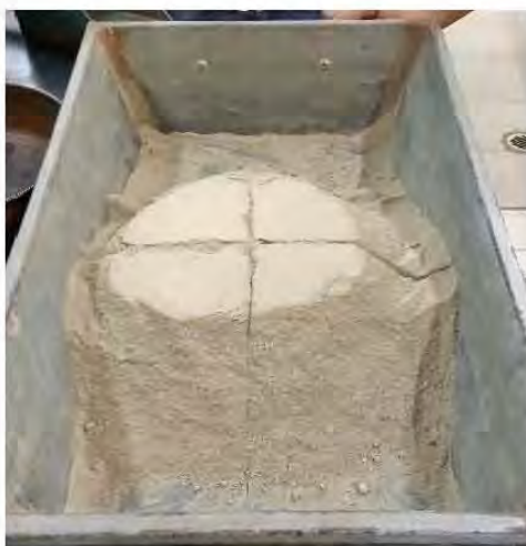
Figura 3.2. Método de cuarteo en el material de excavación
