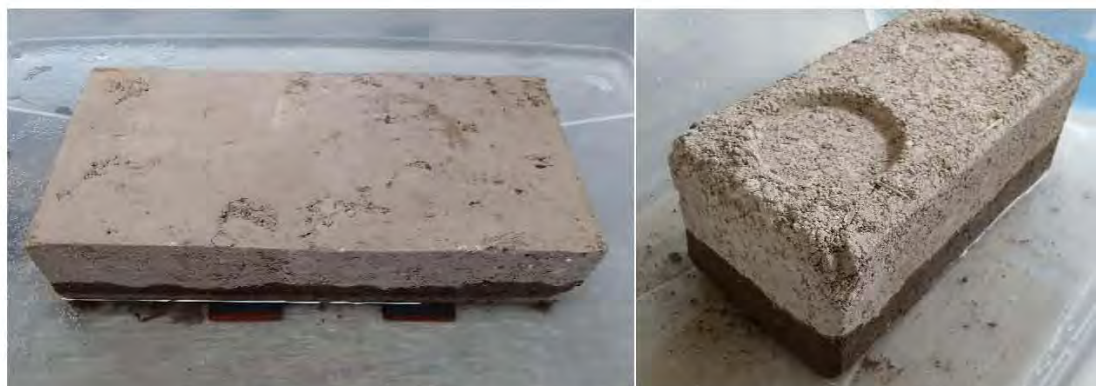
Figura 4.21. Prueba de absorción máxima inicial en ladrillos y bloques
