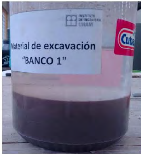
Figura 4.5 Prueba granulométrica en campo
