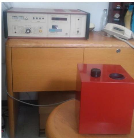
Figura V.17 Exhibe el Susceptibilímetro Kappabridge KLY-2 donde se realizaron las mediciones de Susceptibilidad Magnética y Anisotropía de Susceptibilidad Magnética.
