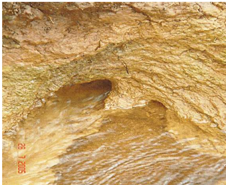
FIGURA 2.9: Fotografía que muestra el flujo de agua a través de las tubificaciones presentes en las lutitas del subsuelo. Imagen tomada de (Montiel, 2015).
