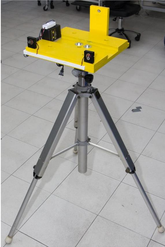
**Figura 4.9 Base para el irradiador con sistema de láseres apuntadores montada sobre tripié.**
