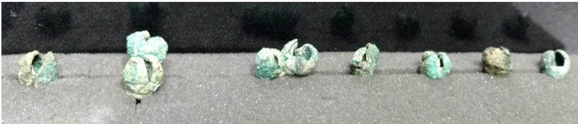
**Figura 5.1 Cascabeles de cobre prehispánicos del Templo Mayor de Tenochtitlán montados frente al detector de rayos X sobre una superficie radiotransparente. Trabajo hecho en colaboración con el Taller de Metales de la Escuela Nacional de Conservación, Restauración y Museografía (ENCRyM) del Instituto Nacional de Antropología e Historia.**
