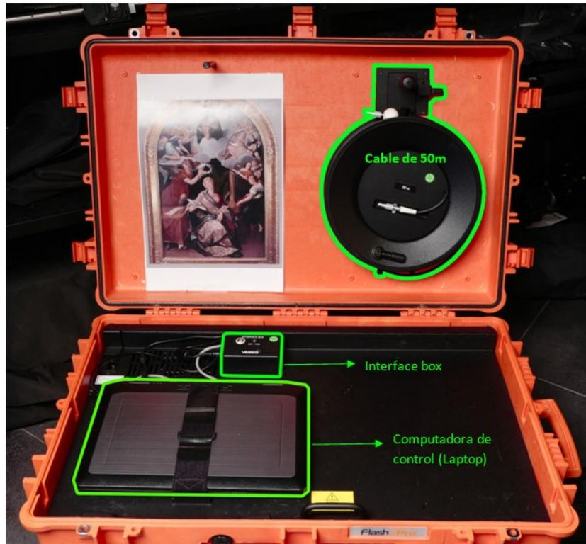
Figura A1.15 Cable de 50m, interface box y laptop
