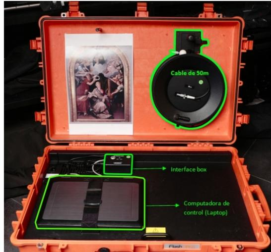
Figura 3.7 Unidad de adquisición. Se muestran la computadora de control, la interface box y el cable de 50 m con el cual esta se conecta al ICU.
