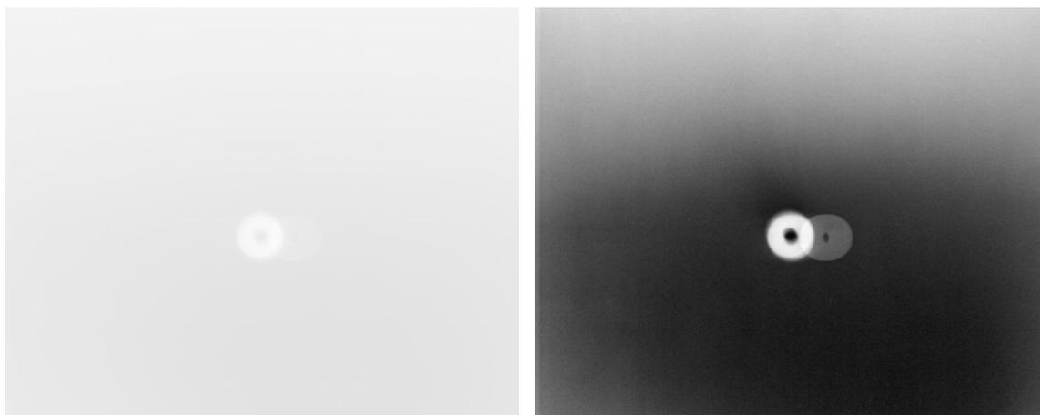
**Figura 5.10** Radiografía de una rondana generada a través de la fluorescencia producida con una película de cobre a  $(70\pm 4.9)\text{kV}$  y  $(50.0\pm 5.0)\text{mAs}$
