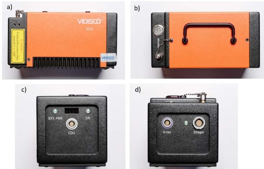
Figura A1.7 a) Vista lateral del ICU. b) Vista superior del ICU. c) Vista posterior del ICU; se observa la entrada de pines del CDU, la luz indicadora de encendido y del cable de corriente. d) Vista frontal del ICU; se observan las entradas de pines del detector, del cable X-ray y la luz indicadora de conexión del detector.
