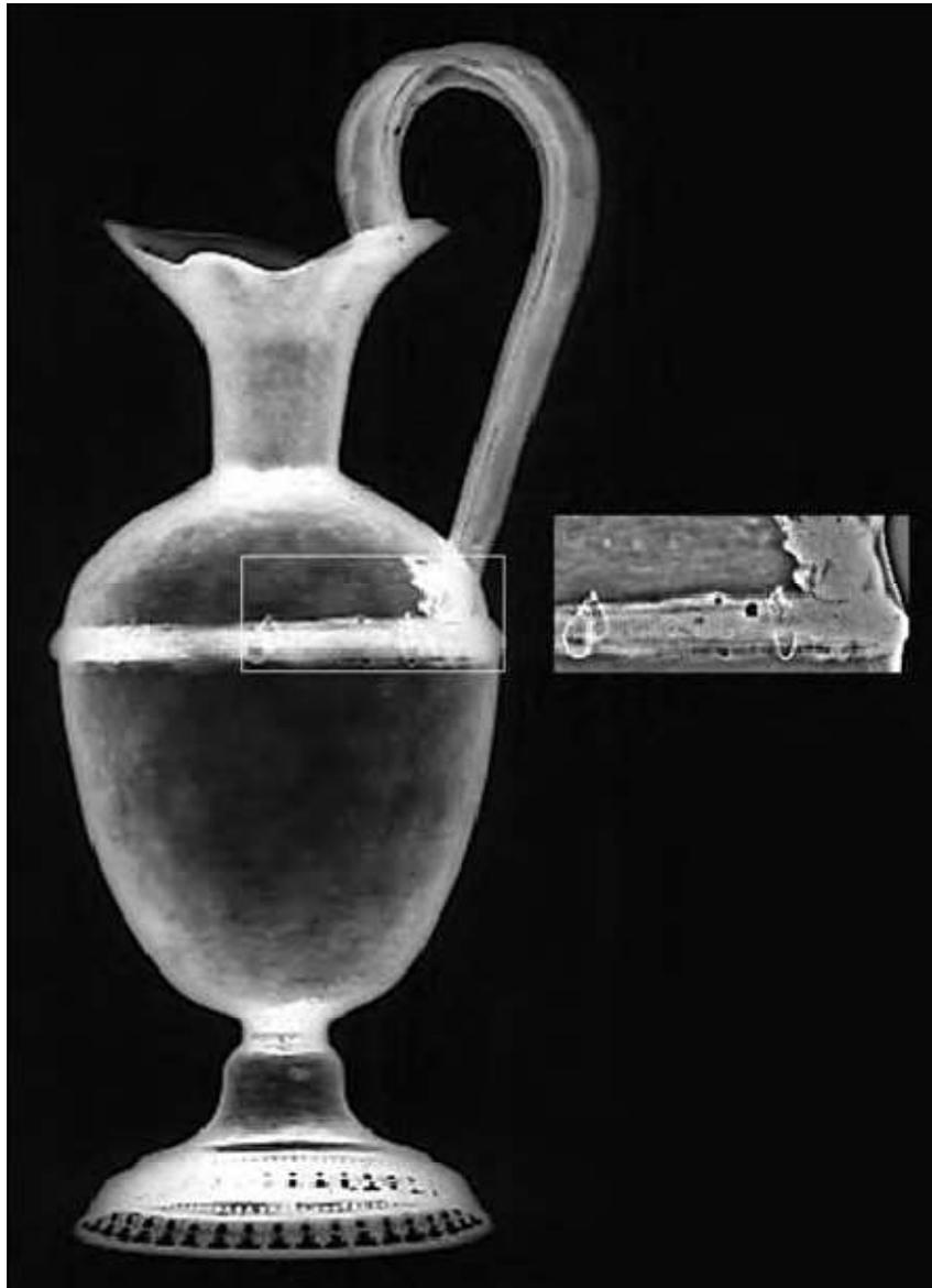
Figura 1.3 [1] Radiografía la cual muestra los alambres asegurando las secciones superior e inferior, las juntas soldadas, las reparaciones de soldadura blanda, la construcción del asa a partir de lámina enrollada. Las variaciones en el grosor del esmalte en el lado de la vasija son visibles en la unión del asa. El detalle enfocado ha sido procesado para mostrar las trenzas de alambre y las variaciones den la capa de esmalte en las juntas.
