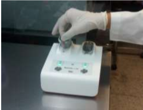
d Fig.4 Forma de inserción del Obturador en el horno Thermaprep. Tomada por: Ángeles Ortiz Leonel.
