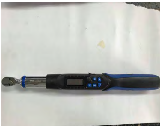
Fig. 5.13 Torquímetro Airon utilizado para el ensayo de corrosión bajo tensión.
