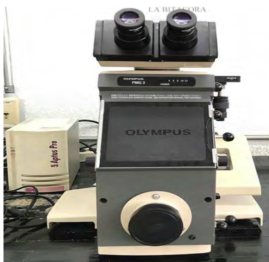
Fig. 5.6 Microscopio metalográfico Olympus PMG 3 utilizado para la micrografía del latón.
