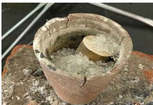
Fig. 5.1 Crisol de cerámico con latón y vidrio antes de su fusión.
