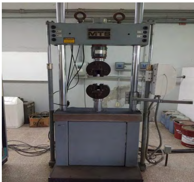
Fig. 5.11 Maquina universal para la elaboración del ensayo de tensión.
