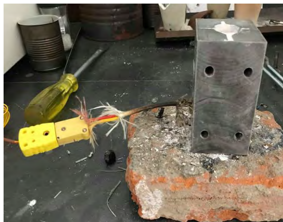
Fig. 5.4 Molde de acero con pintura refractaria en el interior, a) Entrada del termopar tipo k a una distancia del centro de la cavidad cilíndrica.
