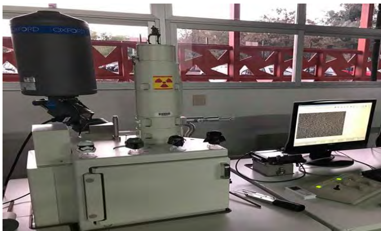
Fig. 5.8 Microscopio electrónico de barrido JEOL JSM-5910 utilizado para el microanálisis semicuantitativo.
