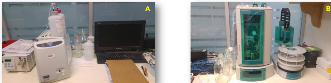
Figura 30. Equipos Analíticos. A: Cromatógrafo Thermo Scientific Dionex ICS-900 para análisis de cationes; B: Cromatógrafo Metrohm ProfIC-881 TM para análisis de aniones.
