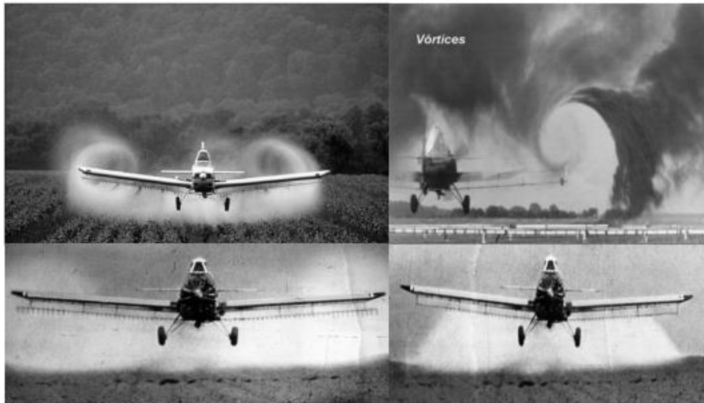
Figura 2. Las imágenes de arriba muestran la aspersión afectada por vórtices que se generan por efecto de las alas del avión, y las de abajo representan la corrección de las barras de aspersión para que no se vea afectada por los vórtices.
