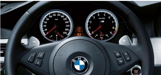
Ilustración 15. Paletas de cambio en una transmisión semiautomática.
