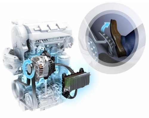
Ilustración 9. Al quitar el pie del embrague, se apaga el motor.
