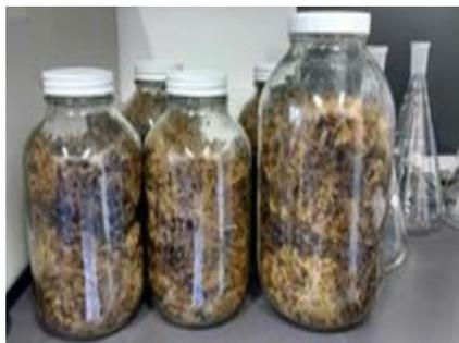
**Figura 8.** Almacenamiento del musgo con el aerosol colectado.
