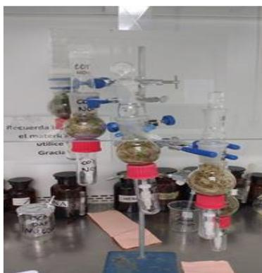
**Figura 10.** Extracción de los HAP en musgo aplicando la CEMAUF modificada.
