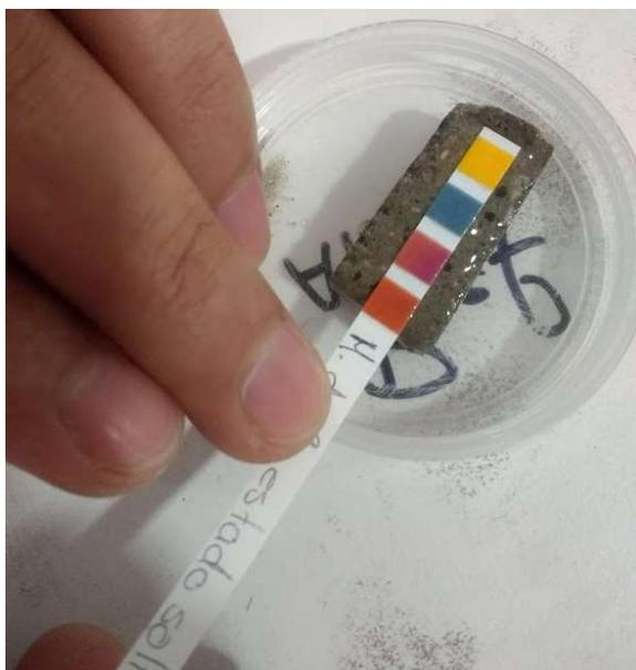
*Imagen 39* Medición del ph de las muestras secas, hidratadas al punto de saturación previamente con agua destilada
