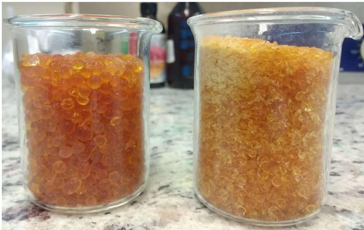
**Imagen 9** *Sílica gel convencional (izquierda) y Sílica gen después del proceso de molienda mecánica (derecha)*
