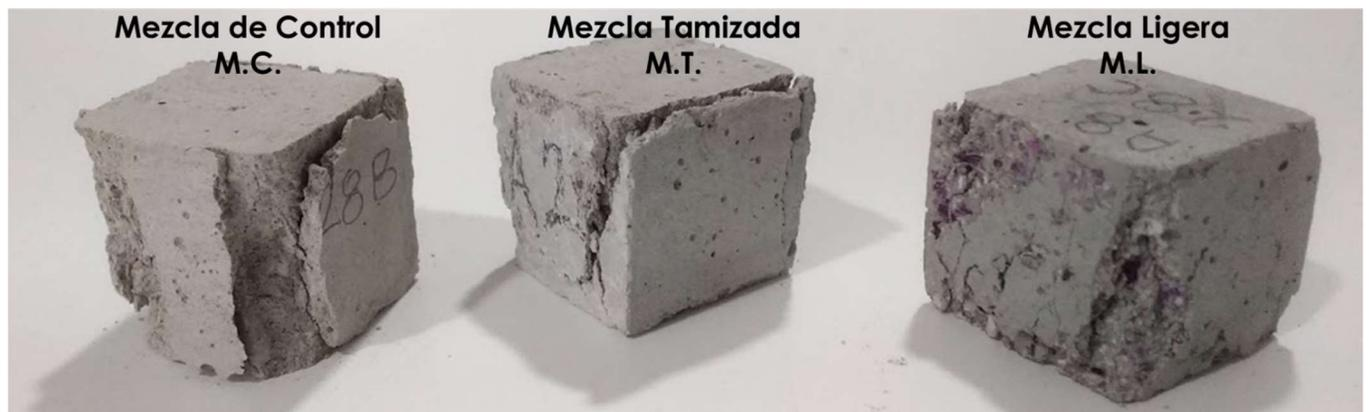
**Imagen 25** Deformación de las probetas cúbicas de 3cm, después de la prueba de compresión, en la cual el equipo se detuvo automáticamente cuando el material mostraba una pérdida del 40% de su resistencia con relación a la carga máxima, esta prueba se realizó en el Laboratorio de Materiales y Sistemas Estructurales, de la Facultad de Arquitectura de la UNAM.
