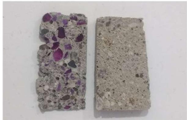
**Imagen 14** Corte transversal de una muestra cubica de 3cm para microscopia Óptica de la mezcla de control y la mezcla ligera, en secciones no mayores de 2mm de espesor
