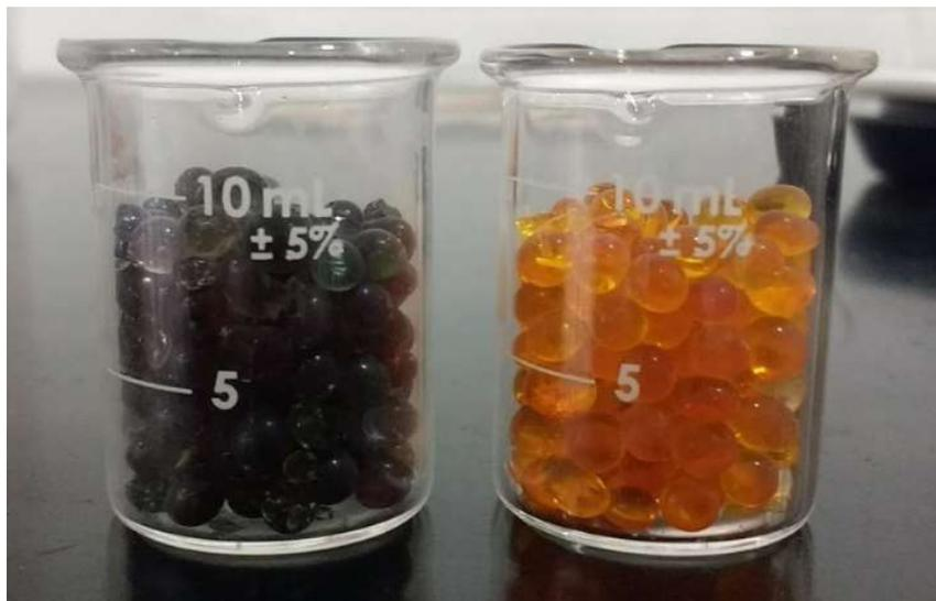
*Imagen 8* Sílica gel saturada de humedad (izquierda) y Sílica gen sin saturar (derecha)
