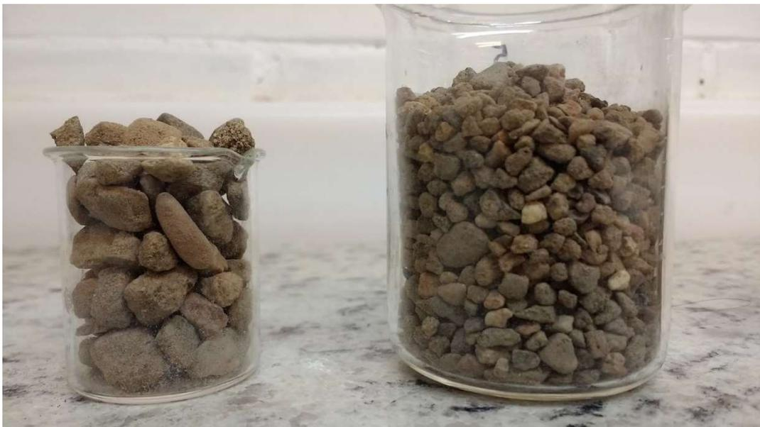
*Imagen 22 Separación de la arena por tamaño de grano como lo establece la norma ASTM C-33.*
