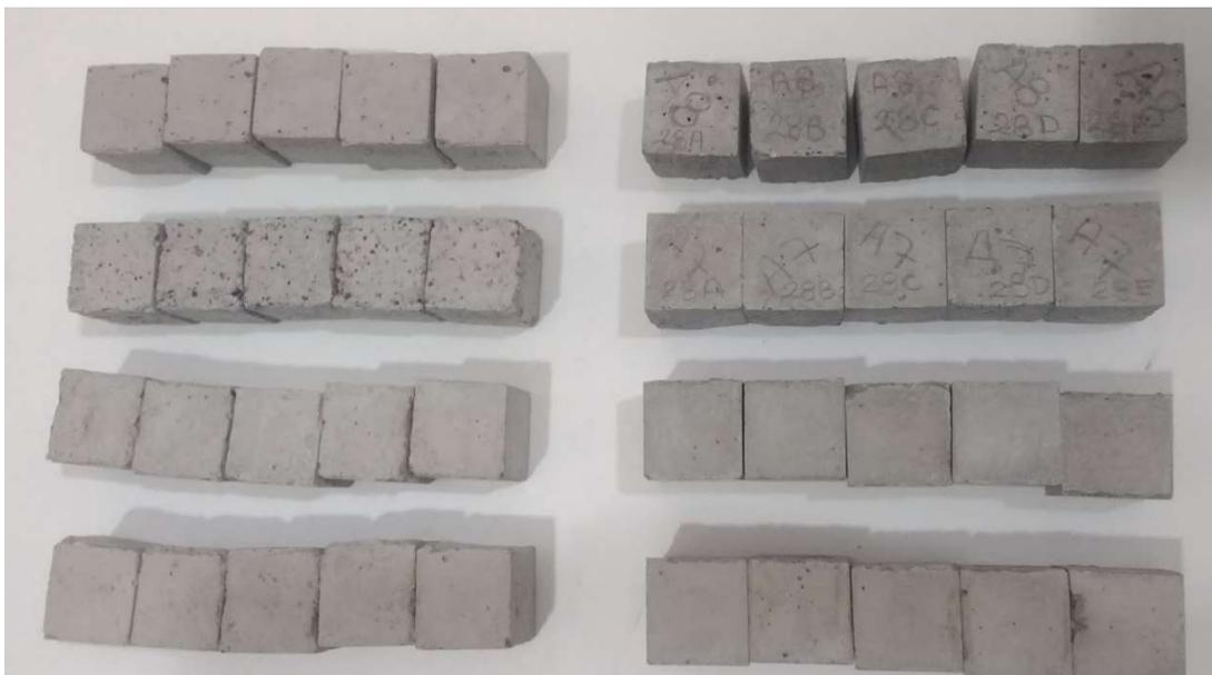
*Imagen 12* Probetas cúbicas de 3cm utilizadas para las pruebas de compresión a 28 días.
