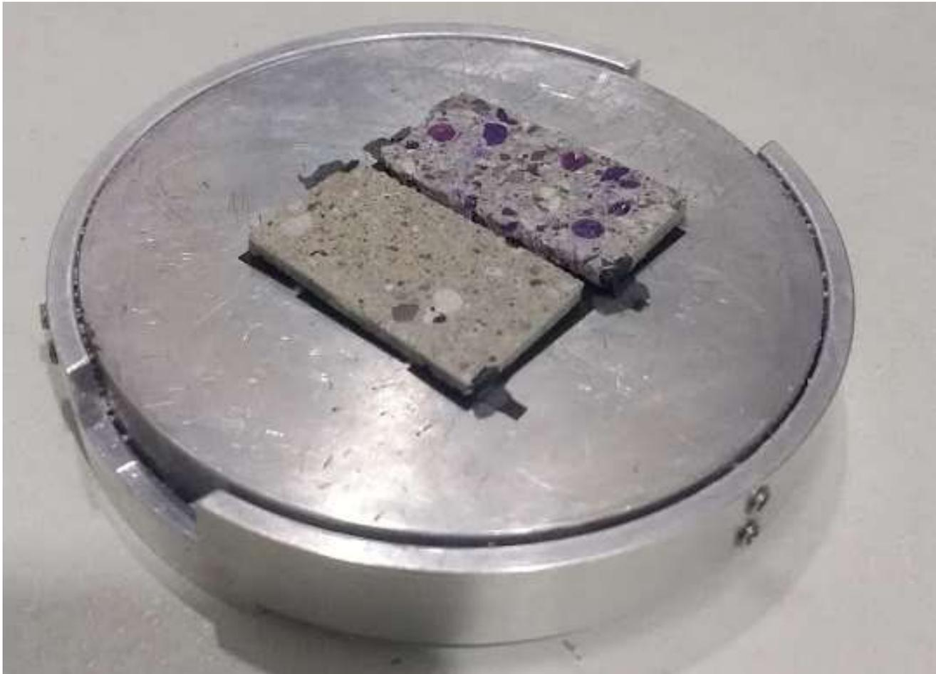
**Imagen 18** Preparación de las muestras, cortadas previamente con un espesor no mayor a 2mm, montadas sobre una platina metálica y fijadas a ella con cinta de carbón para mejor la conductividad de electrones.
