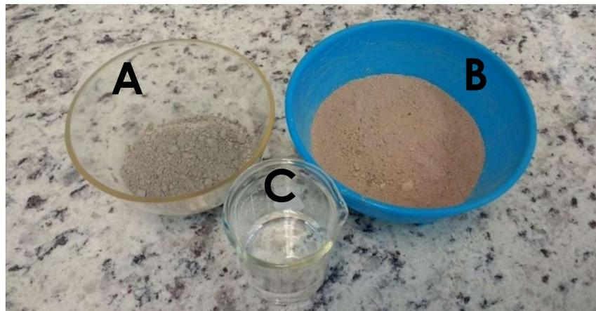
**Imagen 2** Agregados para mezclas de mortero A) Cemento portland B) Arena C) Agua
