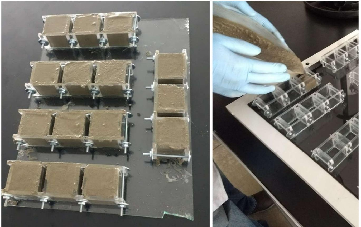
*Imagen 11* Colado de 15 muestras cúbicas de 3cm por cada diseño de mezcla
