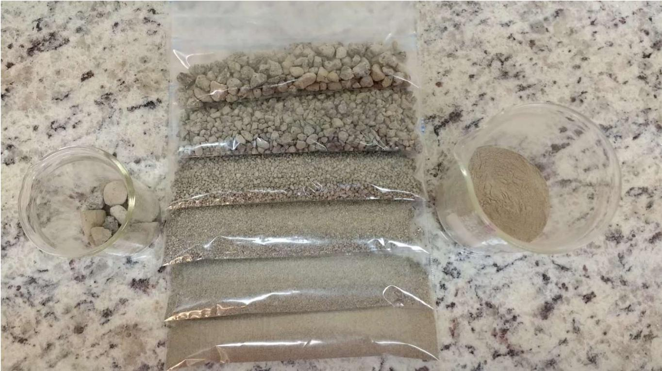
*Imagen 7* Tamizado de la arena rosa, separándola por tamaño de grano, establecido por la norma ASTM C-33.
