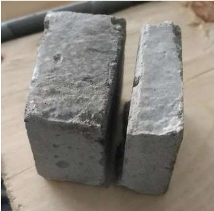
*Imagen 29* Muestra cubica de 3cm sin haber sido ensayada a compresión, seccionada por medio de un corte paralelo a uno de sus lados.
