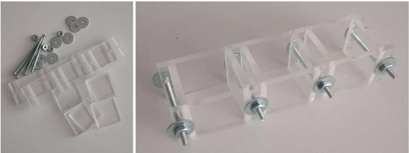
*Imagen 10* Moldes cúbicos de 3cm, elaborados con acrílico y herrajes metálicos, respetando la geometría establecida por la norma ASTM C-109
