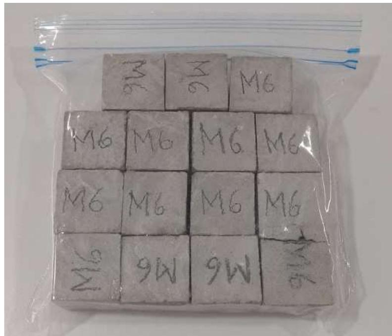
**Imagen 24** Probetas cúbicas de 3cm, clasificadas y resguardadas antes de ser ensayadas.
