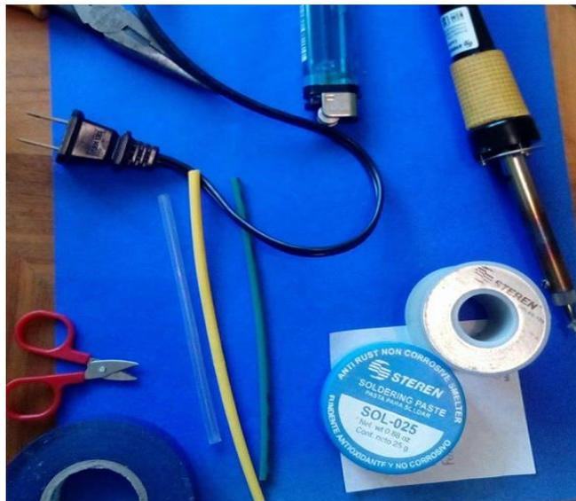
Imagen 8. Material utilizado para poner las conexiones
