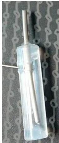
Imagen 3. Electrodo electropulido de referencia.
