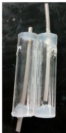
Imagen 5. Electrodo Electropulido-Electropulido
