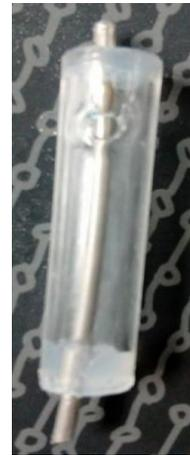
Imagen 4. Electrodo electropulido indicador.
