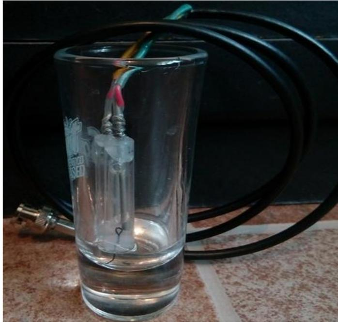
Imagen 9. Electrodo Electropulido-Electropulido con conexión
