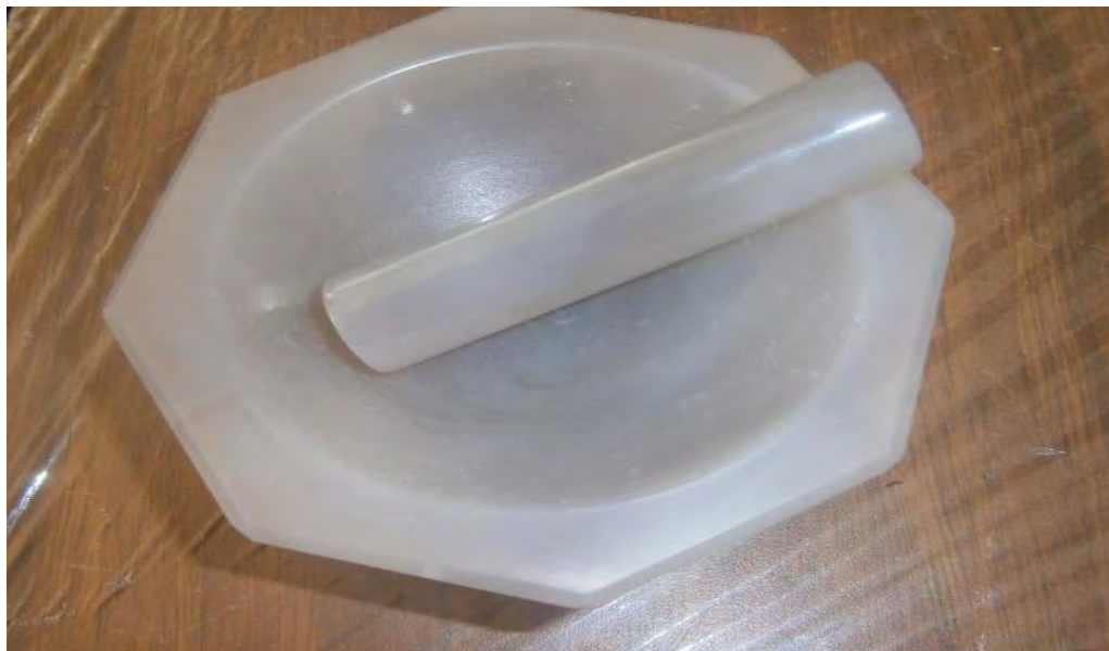
Fig. 24. Mortero Ágata, instrumento con el que se pulverizo.
