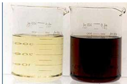
Figura 11 Degradación del aceite y oxidación (Widman, R., 2008)
