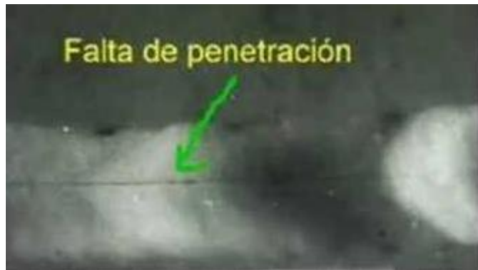
Figura 19 Prueba de radiografía aplicada en una soldadura discontinua (Metalografía Universidad Tecnológica de Pereira)
