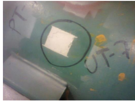
Figura 37 Punto de prueba ultrasónica (Fotografía de campo)
