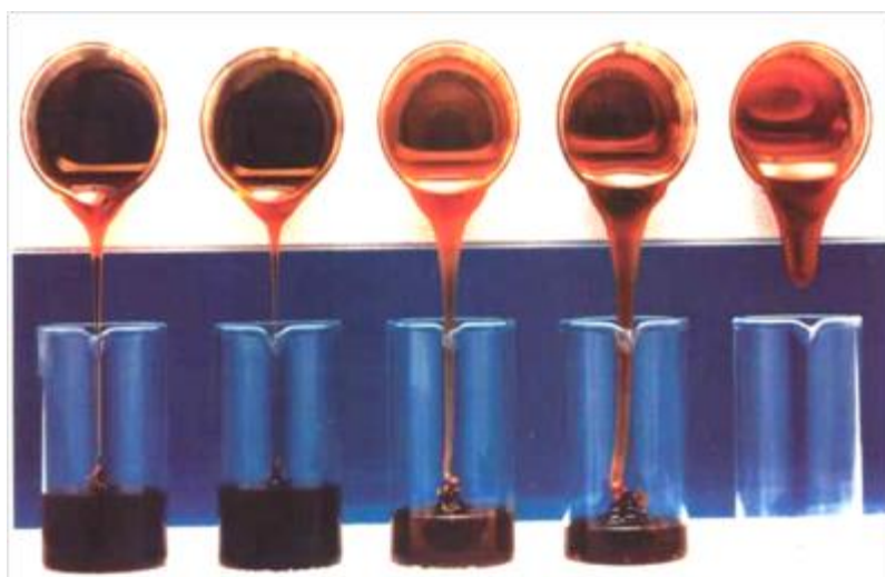
Figura 12 Viscosidad del aceite en función de su temperatura (CASIP CORPORACIÓN S.A., 2015)
