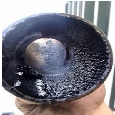
Figura 13 Carbonización del aceite por altas temperaturas (fotografía en campo)
