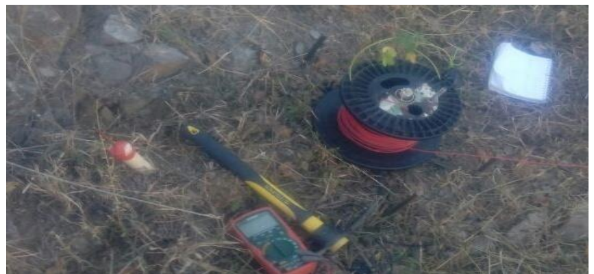
Figura 17. Parte superior: pica, cuaderno, GPS, multímetro con plugs-in, electrodo impolarizable. Parte inferior izquierda: picoleta. Parte inferior derecha: electrodo impolarizable, multímetro, picoleta, cable de 300 m, cuaderno.
