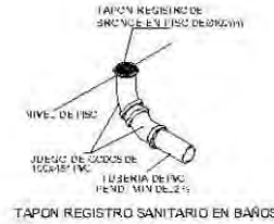
TAPON REGISTRO SANITARIO EN BAÑOS
