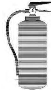
EXTINTOR-VISTA FRONTAL TIPO PDS-DIÓXIDO DE CARBONO
