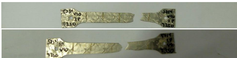
Figura III-24 .Probetas ensayadas a fluencia lenta de la aleación 5754 procesada por RCS mostrando una rotura en el área de trabajo.
