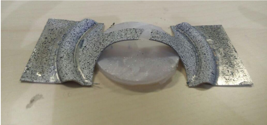
Figura III-29 . Rotura de una lámina de la aleación 5754 utilizada para trazar las curvas de límite de conformado.
