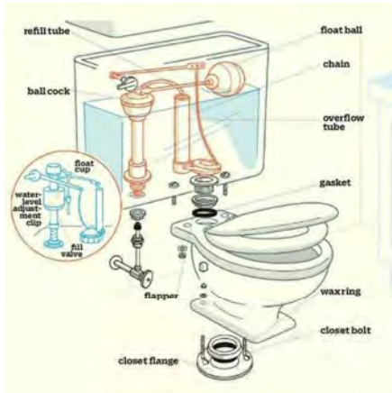
Imagen objetivo – Colocación de piezas de un equipo sanitario
