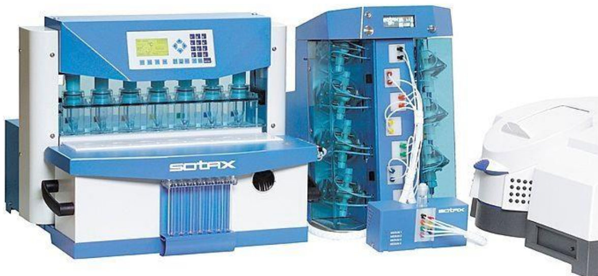
Figura 7. Aparato de Disolución USP IV (Sotax)
