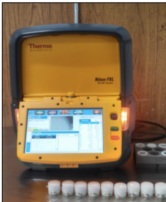
Figura 9 Equipo de FRX utilizado para estimación de las concentraciones de elementos mayores y traza en las muestras colectadas de Cuenca Cieneguilla.
