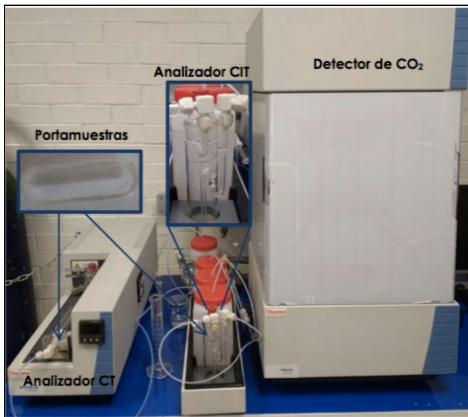
Figura 11 Equipo HiperTOC utilizado para medición de las concentraciones de carbono orgánico total y carbonatos en las muestras de la Cuenca Cieneguilla.
