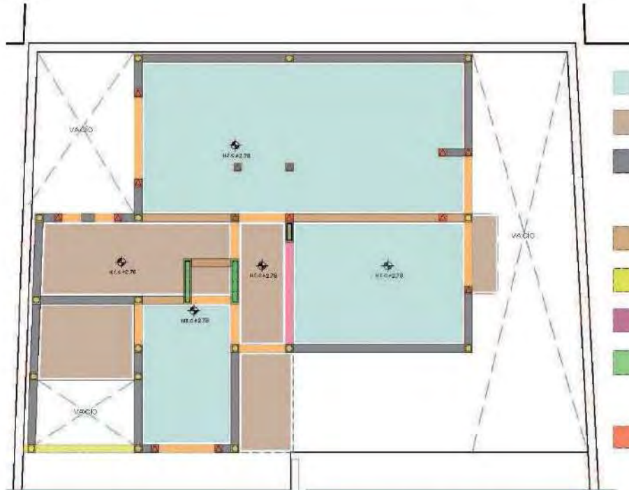
ENTREPISO VIGUETA Y BOVEDILLA Y LOSA DE CONCRETO ARMADO
