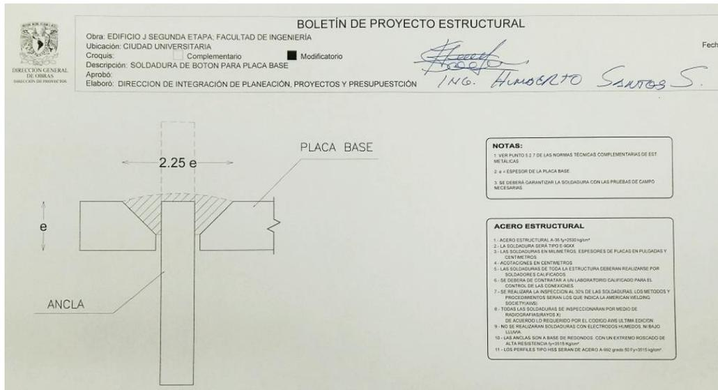
Figura 2.13 Boletín de cambio de la conexión a soldadura de botón
