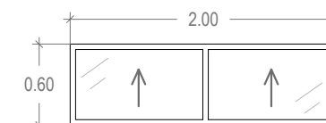
Ventana proyectantes de aluminio blanco, con marco de 4 cm y cristal de 6 mm., utilizada en fachada sur
