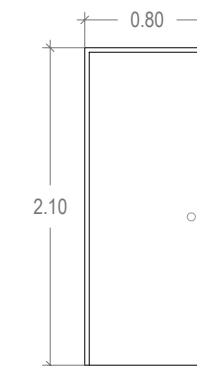
Puerta de acero utilizada en cuarto de servicios y ducto de instalaciones
