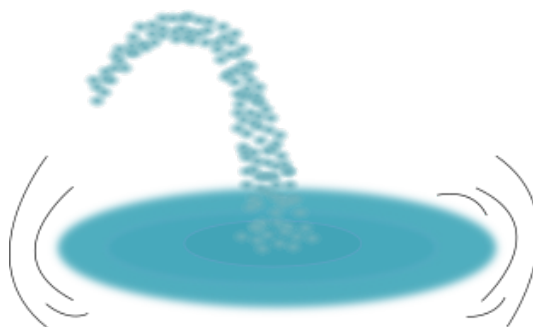
Figura 2.2: Generación de un géiser sobre una superficie líquida por medio de vibraciones ultrasónicas.
