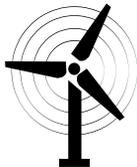
En la actualidad se utiliza, sobre todo, para mover aerogeneradores. En estos la energía eólica mueve una hélice y mediante un sistema mecánico se hace girar el rotor de un generador, normalmente un alternador, que produce energía eléctrica. Para que su instalación resulte rentable, suelen agruparse en concentraciones denominadas parques eólicos.
