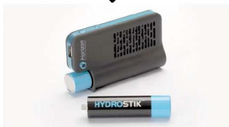
El Horizon MiniPak, utiliza una combinación de celdas de combustible PEM (membrana de intercambio de protones) de producción masiva y una nueva solución de almacenamiento de hidruro metálico de bajo costo, que es capaz de almacenar hidrógeno de forma segura como un material seco, no tóxico y no presurizado.
