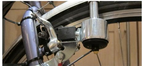
Imagen 20 Dinamo anclado a una llanta de bicicleta, tecnología antigua, pero muy factible para esta edad moderna.
