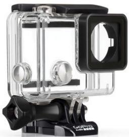
**Imagen 41** Carcasa exterior, que protege a una cámara de acción, principalmente fabricada con Poliestireno de Alto Impacto y que resiste golpes y profundidades máximas a 30 metros.
