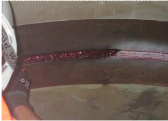
Figura 10. Aplicación de líquidos penetrantes
