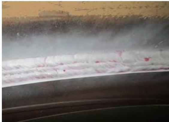
**Figura 9.** Método de inspección por líquidos penetrantes
