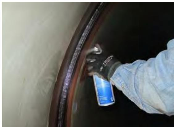
Figura 11. Aplicación de liquido revelador
