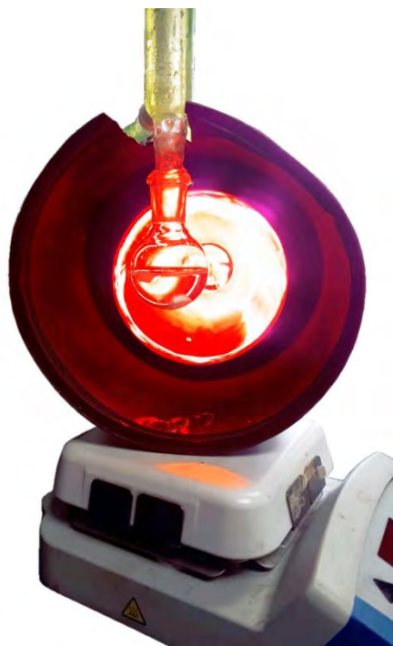
Figura 20.- Equipo de infrarrojo y reacción en proceso.
