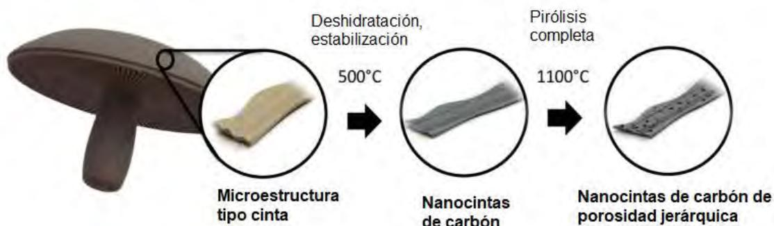
Figura 15. Obtención de materiales de carbón de porosidad jerárquica para su implementación en baterías de litio. Adaptada de [95].
