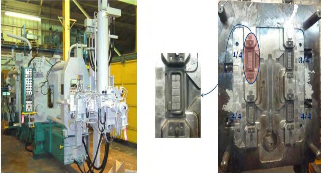
Figura 3.2. a) Máquina del proceso HPDC, b) Cavidad de molde permanente y c) Molde permanente con 4 cavidades [1].
