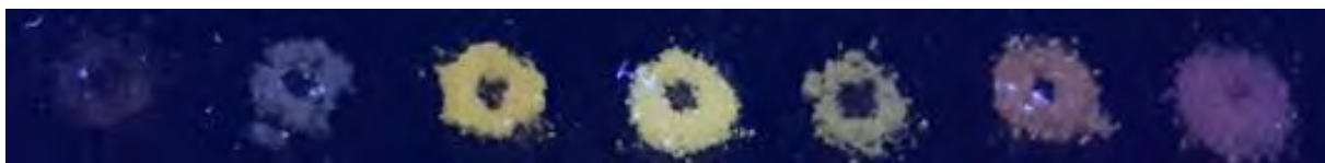
Figura 36. Compuestos del tipo [\text{Au}_2(\text{SR}_F)_2(\text{dppe})] bajo la luz UV de 365 nm, de izquierda a derecha \text{SR}_F = \text{SC}_6\text{F}_5 2 , \text{SC}_6\text{HF}_4 3 , \text{SC}_6\text{H}_3\text{F}_2 -3,5 4 , \text{SC}_6\text{H}_4\text{CF}_3 -4 12 , \text{SC}_6\text{H}_3\text{F}_2 -2,4 6 , \text{SC}_6\text{H}_4\text{CF}_3 -2 11 , \text{SC}_6\text{H}_4\text{F} -3 8 .
