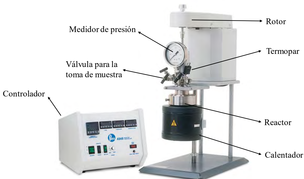
Figura 24. Reactor por lotes utilizado para la hidrodesulfuración del DBT.
