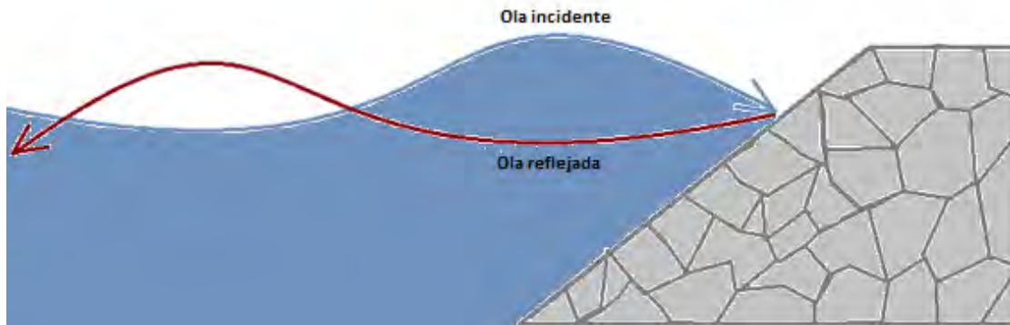
Figura 1. 7 Reflexión del oleaje
