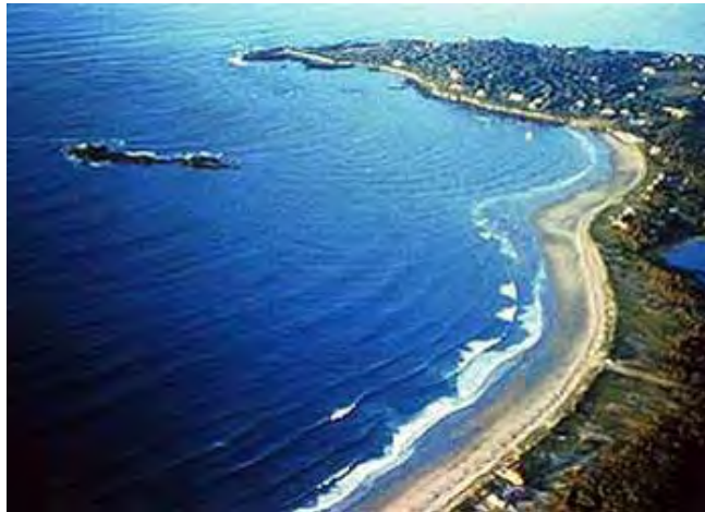
Figura 1. 5 Refracción del oleaje (Tomada de www.uc.cl )
