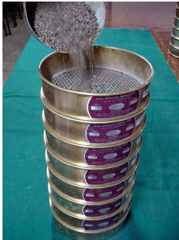
Figura 2. 2 Análisis Granulométrico con cribas
