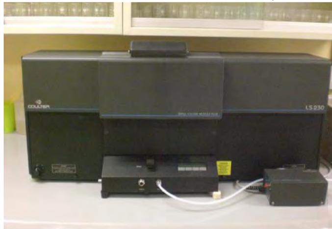
**Figura 20.** Analizador láser de partículas Beckman Coulter modelo LS 230, del Laboratorio de Sedimentología del Instituto de Ciencias del Mar y Limnología, UNAM.
