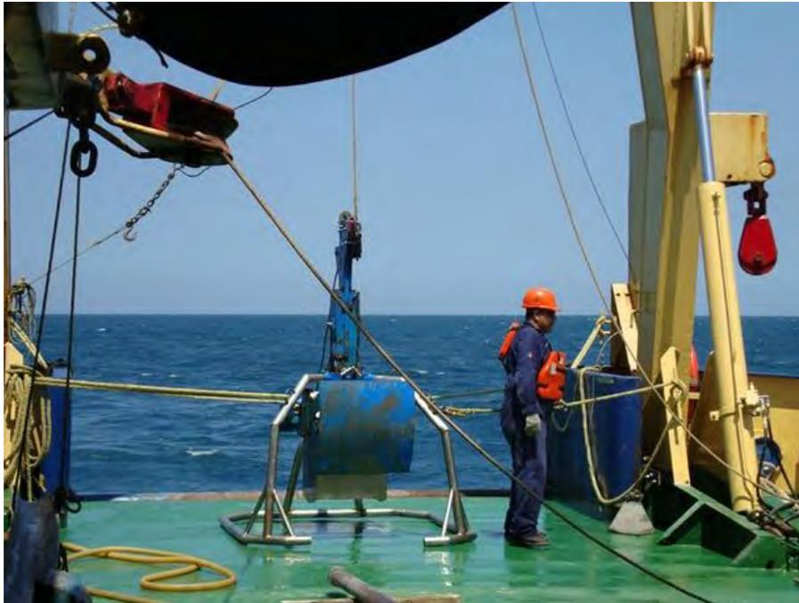
*Figura 17. Recuperación de sedimentos mediante un nucleador de caja.*
