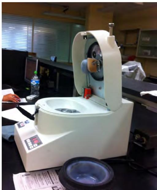
**Figura 21.** Pulverizador Fritsch 2 de mortero de ágata. Laboratorio de Geoquímica, ICML.
