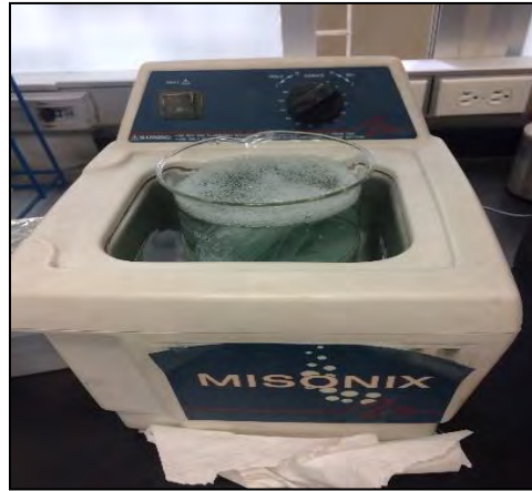
Figura 19. Limpieza de sustratos en equipo ultrasónico.
