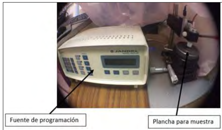
Figura 24. Esquema de equipo Jandel.
