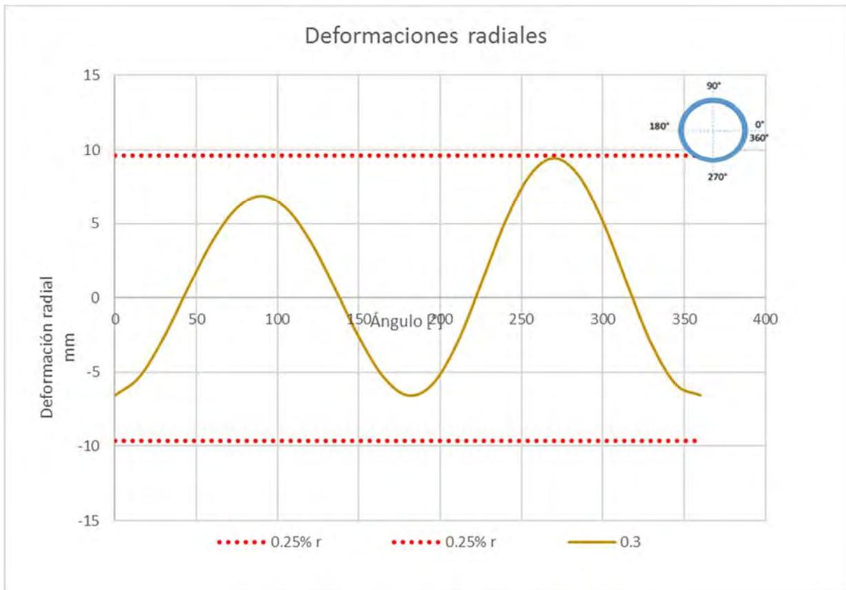
Figura 4.3. Deformaciones radiales del anillo de dovelas
