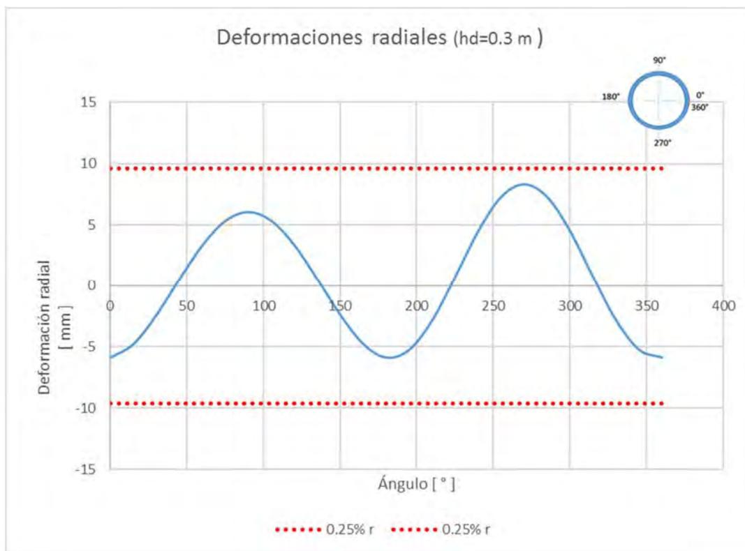
Figura 4.15. Deformaciones radiales del anillo de dovelas
